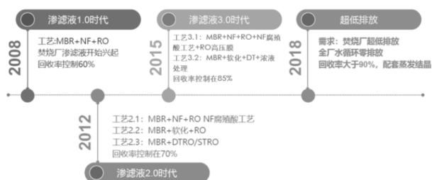
图4 垃圾渗滤液处理工艺流程发展
