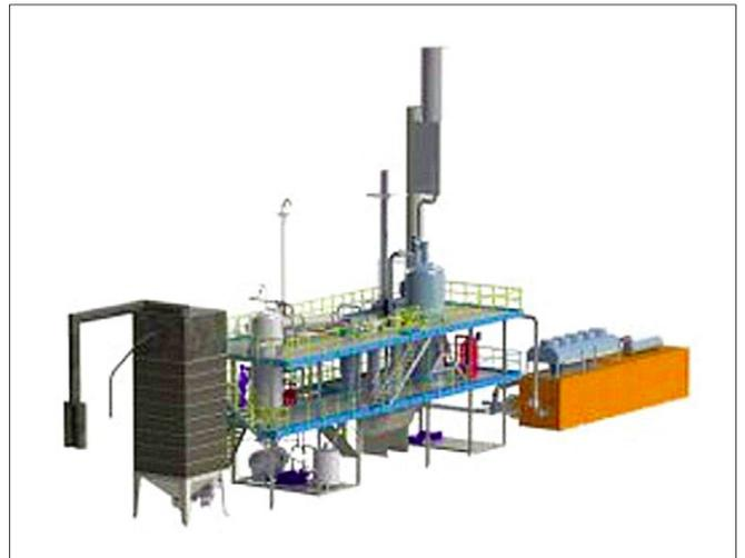
图6 Meva AB VIPP-CHP涡旋气化、气体净化、供热发电系统
