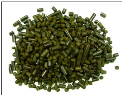
图17 BioEndev生产的生物质椭圆形颗粒燃料
