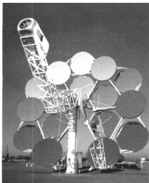
图 4 多碟太阳能热发电系统
